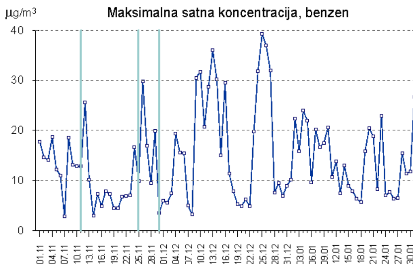
Slika 3.6. Maksimalne satne koncentracije benzena na postaji Slavonski Brod-1 tijekom i nakon razdoblja remonta u Rafineriji Brod, obuhvaćeni studeni i prosinac 2012. i siječanj 2013. godine.
